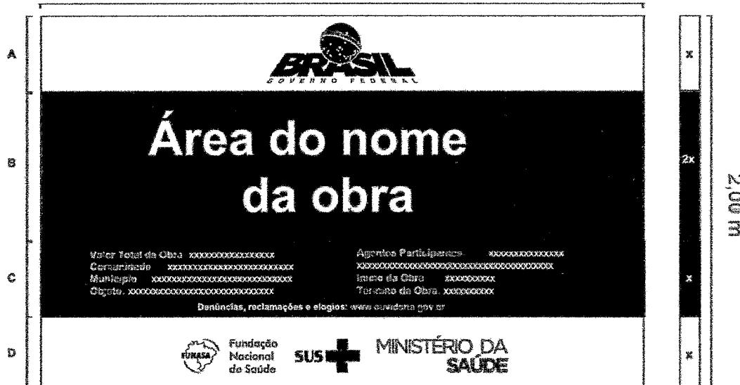
A placa deverá ser colocada sobre o solo, ao lado da obra em execução, utilizando-se estrutura de madeira, de acordo com suas dimensões, conforme indicado pela Fiscalização.
